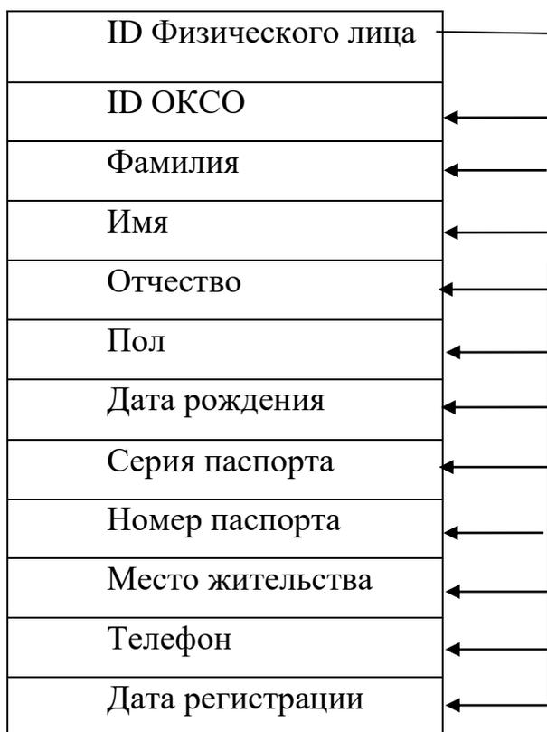
Рисунок 19 – Диаграмма функциональных зависимостей отношения «Физическое лицо»
