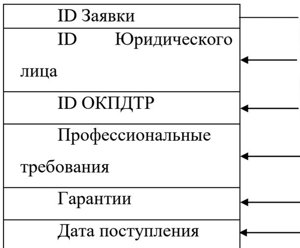
Рисунок 20 – Диаграмма функциональных зависимостей отношения «Заявка»
