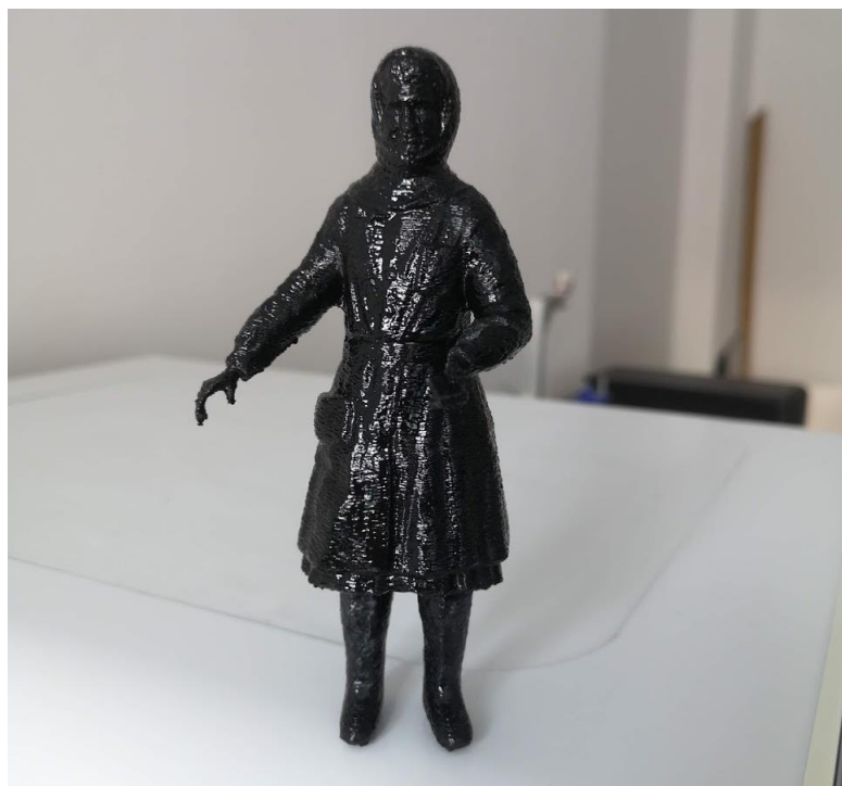
Рисунок 35 – Изделие после нанесения ацетона при помощи кисти
