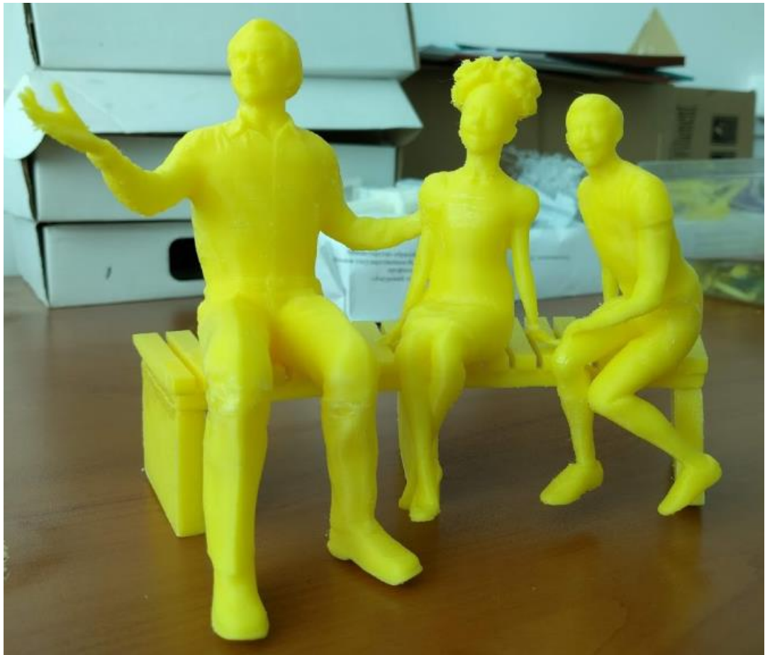
Рисунок 25 – Результат физической обработки изделия, распечатанного ABS-пластиком
