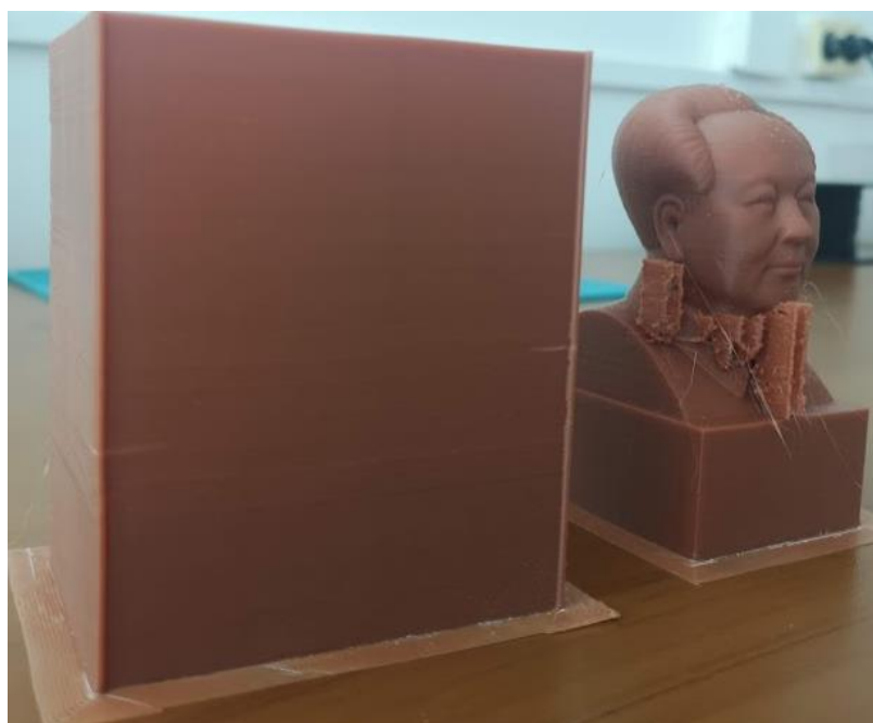
Рисунок 23 – Результат печати с термокапсулой
