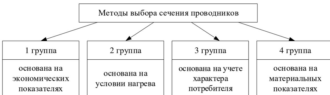
Рисунок 2 – Классификация методов выбора сечений проводников
