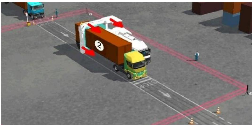
Рисунок 11 – Сканирование транспортного средства системой HCV-Mobile при движении вперед.
