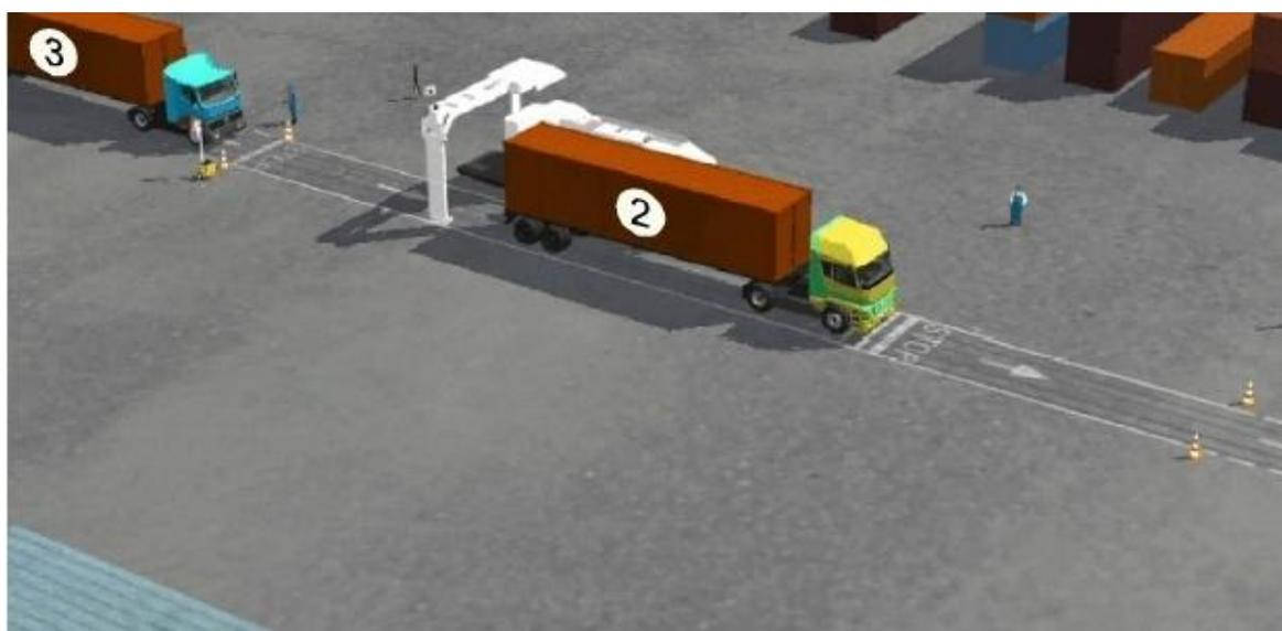
Рисунок 10 – Сканирование транспортного средства под стрелой системы HCV-Mobile.
