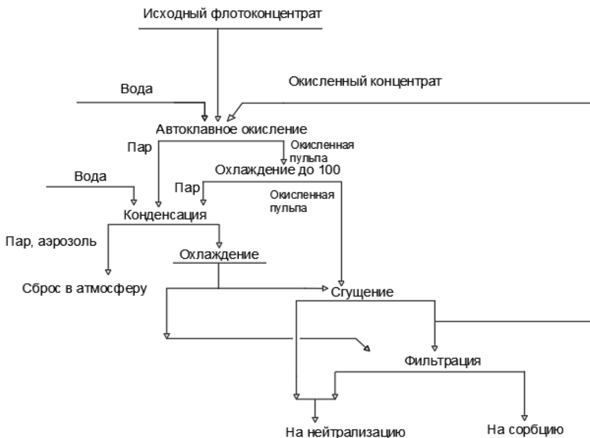
Рисунок 7.1 – Схема процесса автоклавного окисления
