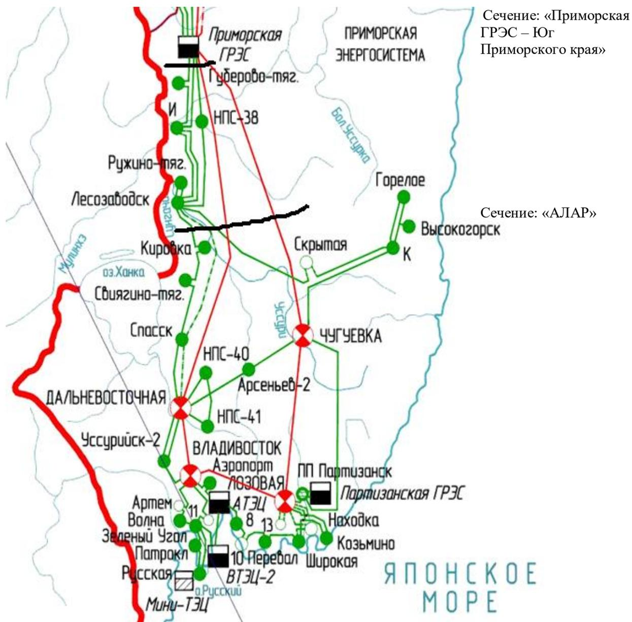
Рисунок 7 – Схема Приморской энергосистемы с нанесенными на ней рассматриваемыми сечениями
