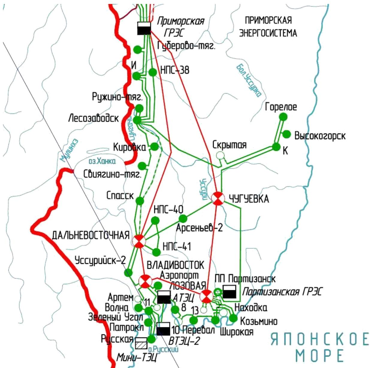
Рисунок 1 – Схема энергосистемы Приморского края
