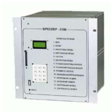
Рисунок 31 – Общий вид устройства РАС Бреслер - 0106
