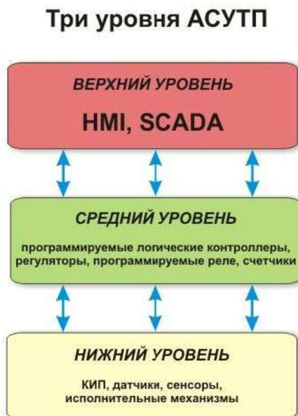
Рисунок 37 – Структурная схема АСУ ТП с распределением по уровням управления
