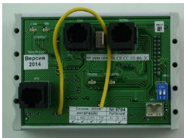
Рисунок 40 – Коммуникационный контроллер «Синком-IP/DIN»
