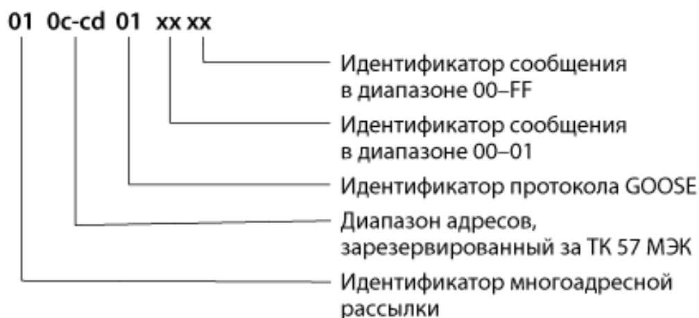
Рисунок 51 – Диапазон адресов многоадресной рассылки по протоколу SV
