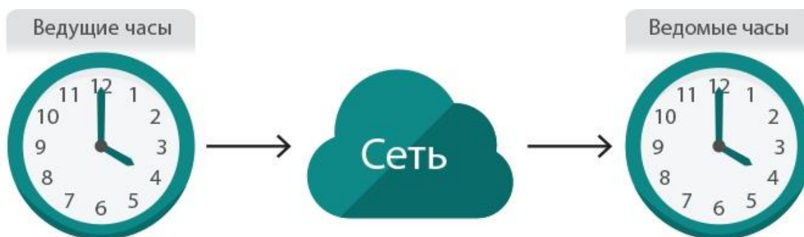
Рисунок 23 - Односторонний метод синхронизации времени
