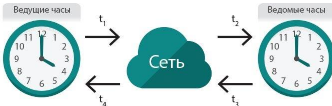
Рисунок 24 - Двусторонний метод синхронизации времени
