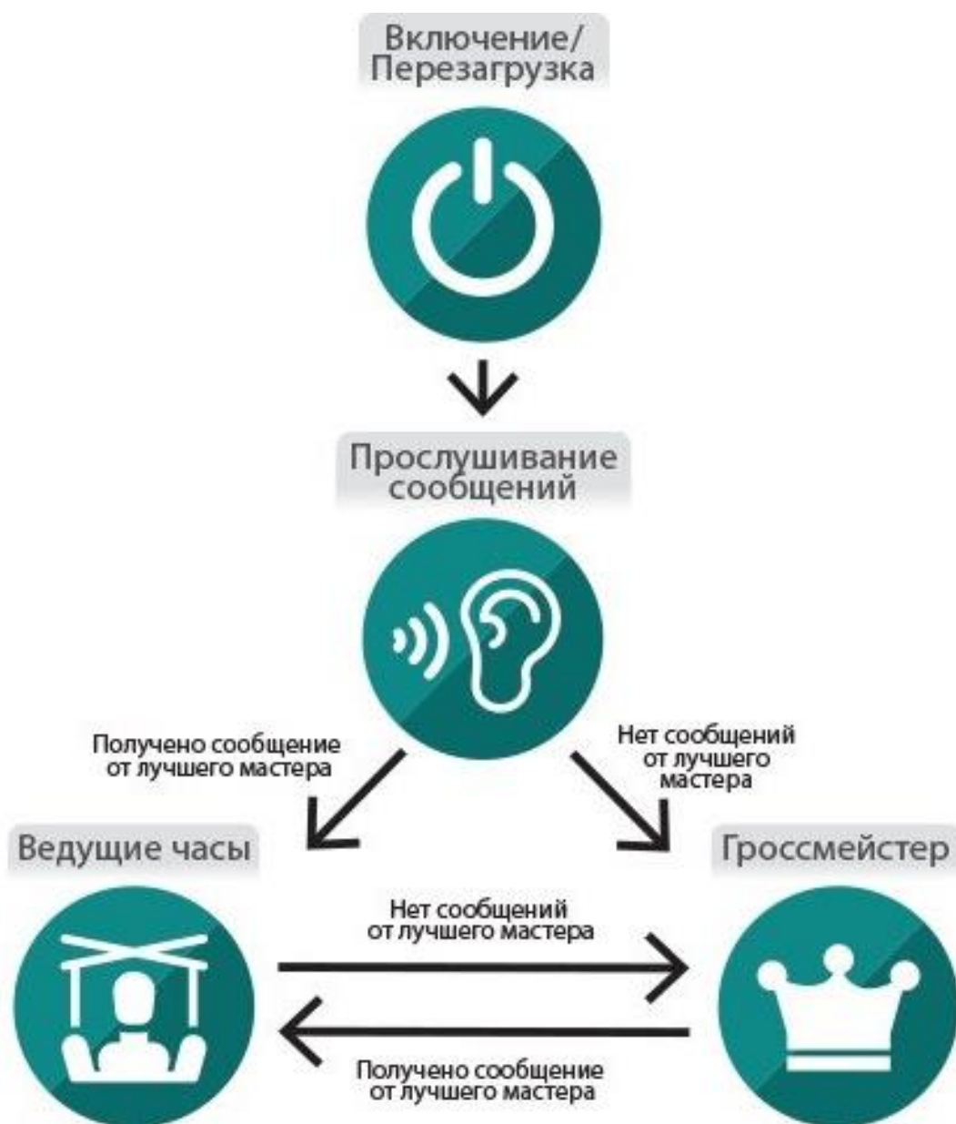
Рисунок 28 - Диаграмма состояний часов в системе
