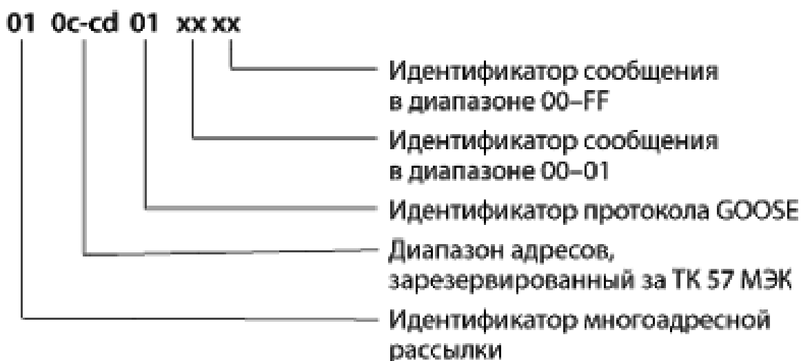
Рисунок 40 – Диапазон адресов многоадресной рассылки для GOOSE-сообщений.
