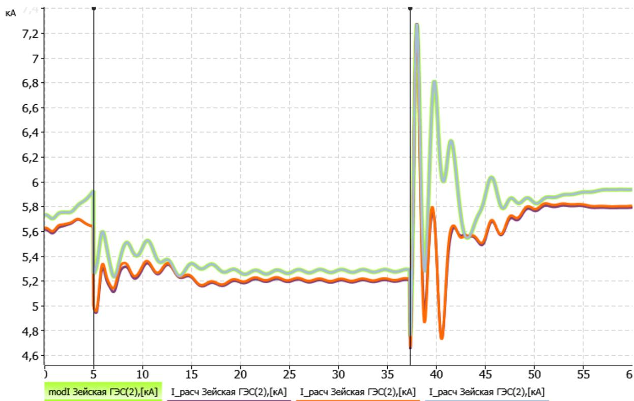
Рисунок 21 - Ток статора генераторов Зейской ГЭС
