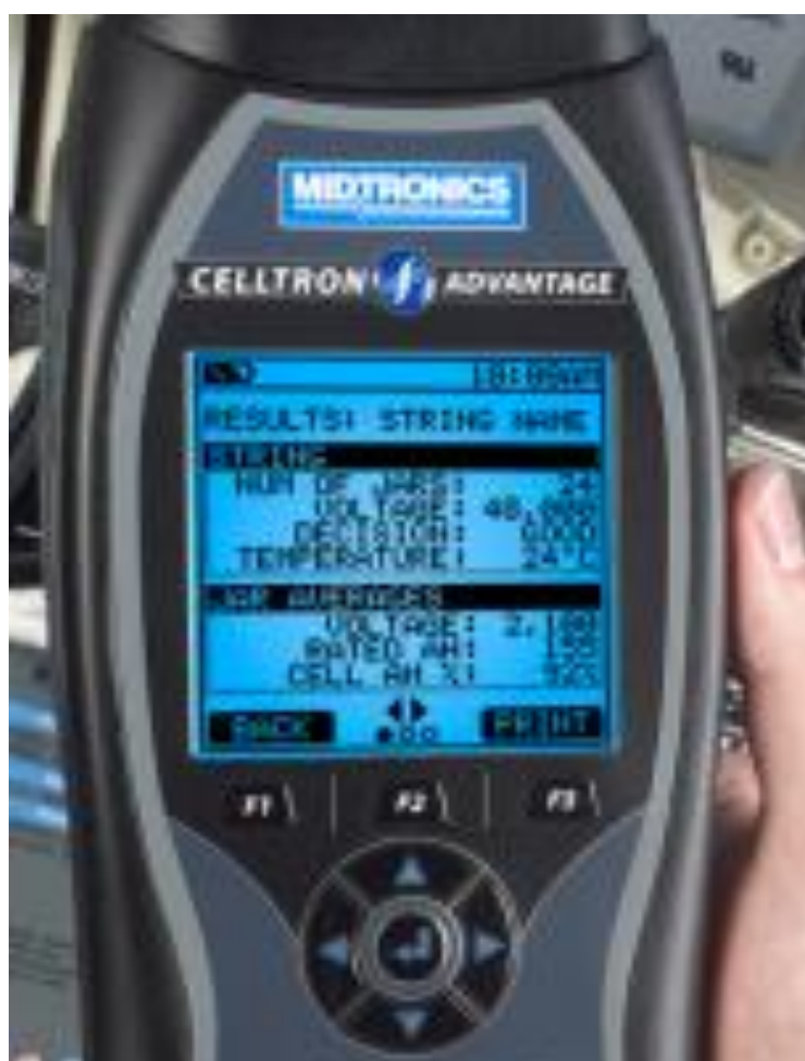
Рисунок 8 – Мультичастотный тестер аккумуляторных батарей Celltron Advantage 5500
