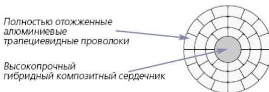
Рисунок 12 – Конструкция алюминиевого провода с композитным сердечником
