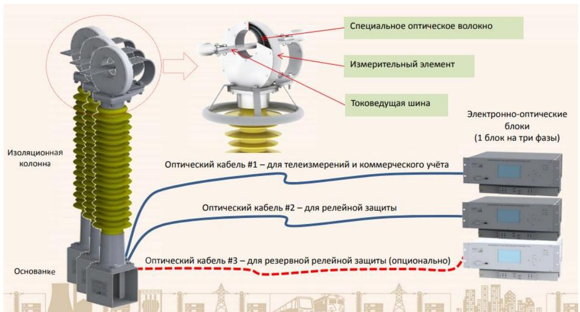
Рисунок 7 - Трансформатор тока электронный оптический
