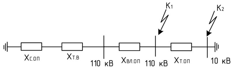
Рисунок – 6 Схема замещения обратной последовательности
