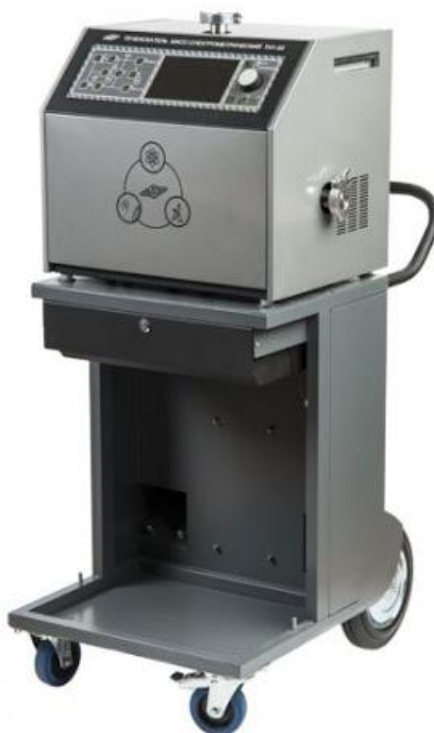
Рисунок 22 – Гелиевый течеискатель ТИ1-50
