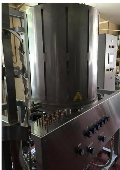
Рисунок 1.1 – Колпаковая вакуумная камера
