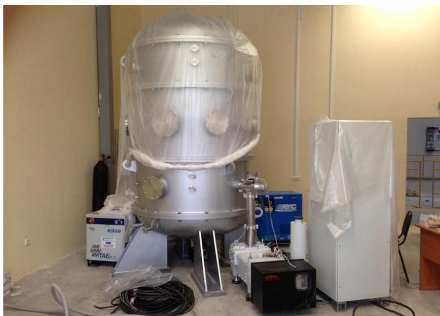
Рисунок 1.4 – Вертикальная камера со съёмной крышкой
