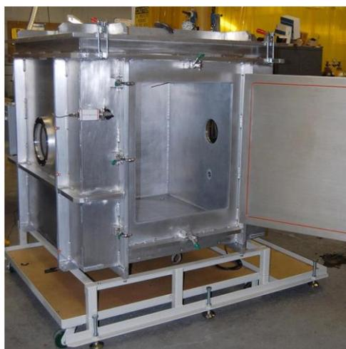
Рисунок 1.3 – Кубическая вакуумная камера
