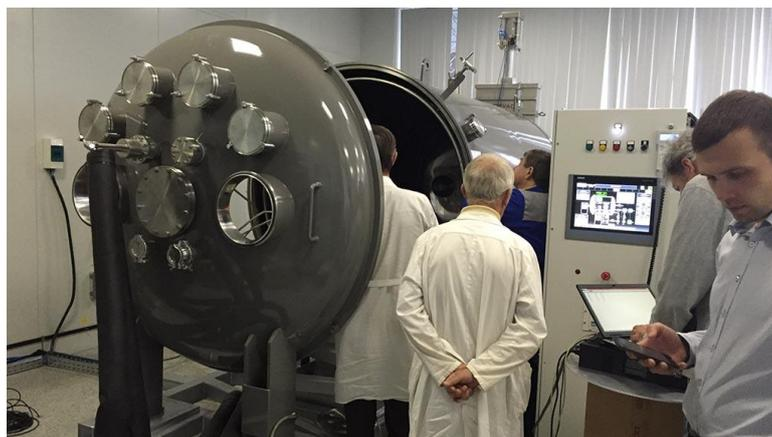
Рисунок 1.2 – Цилиндрическая вакуумная камера
