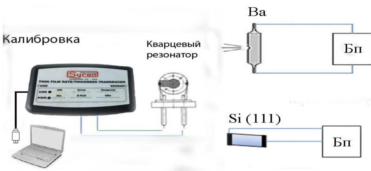
Рисунок 6 – Схема калибровки скорости осаждения источника Ba и Si
