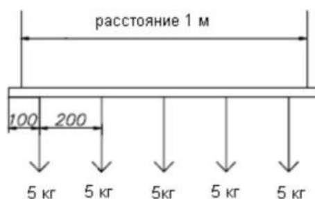
Рисунок 11– Рекомендуемое расстояния крепления
