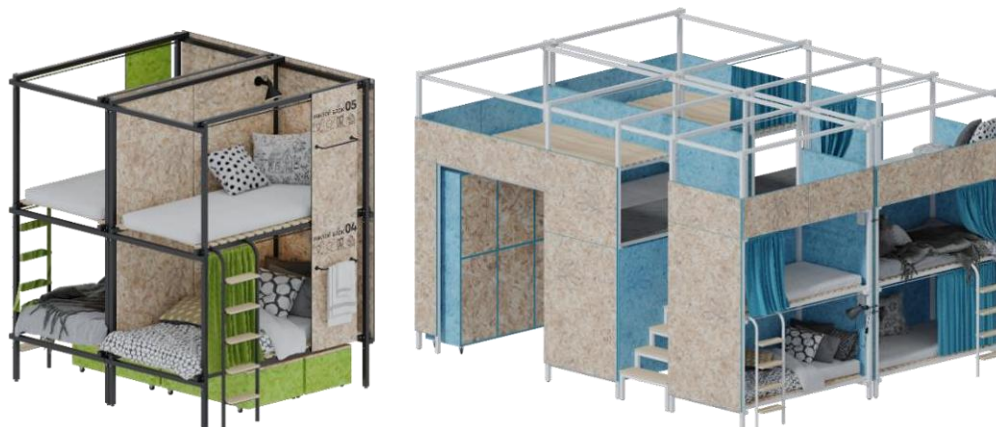
а) Двухуровневая конструкция б) Трехуровневая трансформирующаяся конструкция
