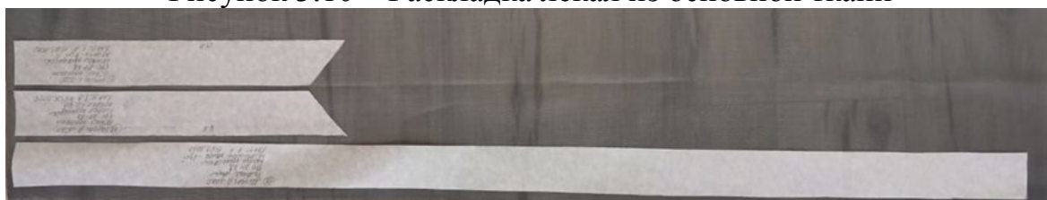
Рисунок 3.11 – Раскладка лекал из прокладочной ткани
