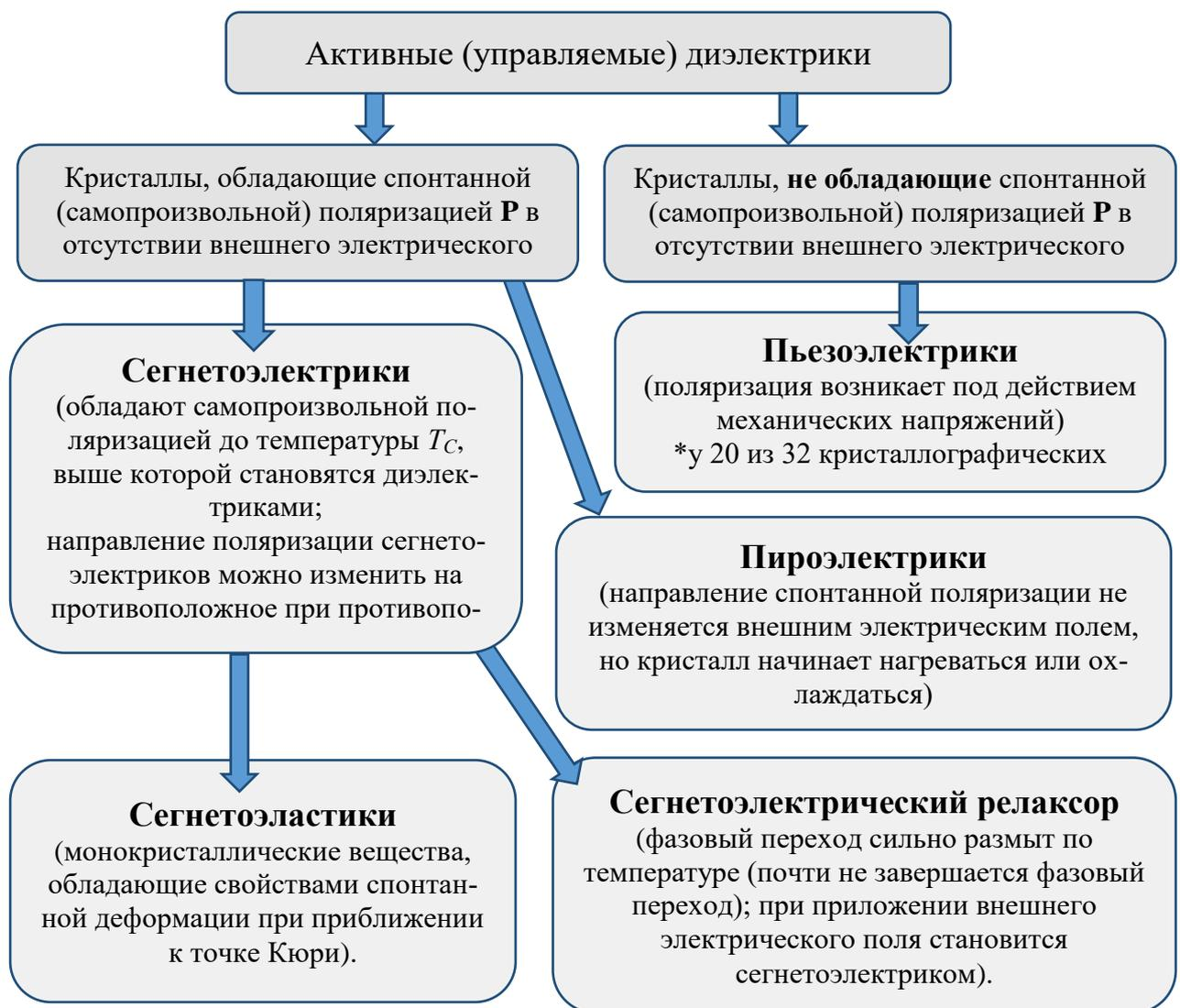
Рисунок 1.2 – Структурная схема активных диэлектриков
