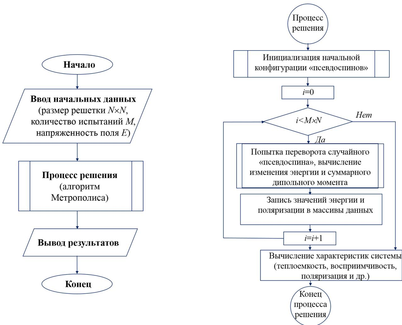
Рисунок 3.2 – Блок-схема алгоритма Метрополиса для реализации 2D-модели Изинга
