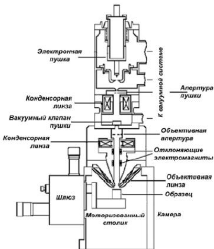
Рисунок 2.1 – Принципиальная схема, РЭМ [10]
