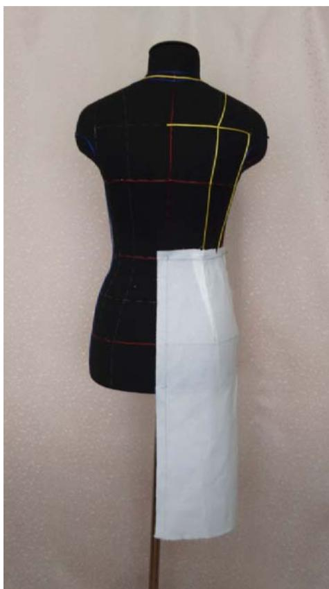
Рисунок Д.14 – Деталь заднего полотнища юбки
