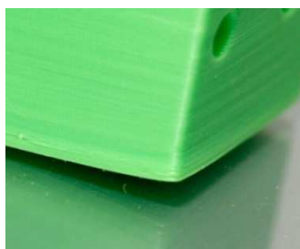
Рисунок 44 – Деформация во время печати
