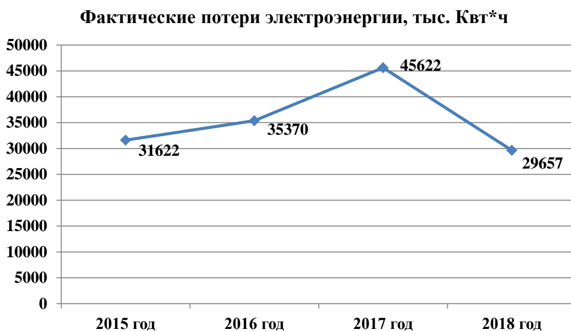
Рисунок 15 – Диаграмма изменения уровня потерь электроэнергии за 2015 – 2018 гг. с учетом всех фидеров ЗРЭС
