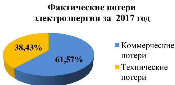
Рисунок 12 – Диаграмма распределения фактических потерь электроэнергии в процентном соотношении технической и коммерческой составляющих за 2017 год
