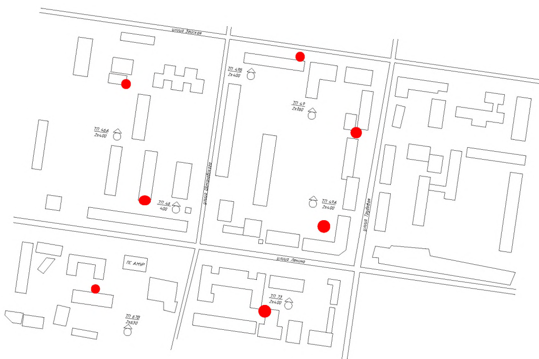
Рисунок 3 – Рассчитанные центры нагрузок и существующее место положение ТП
