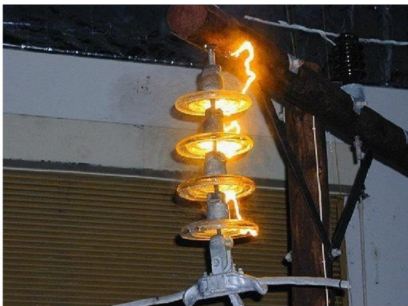
Рисунок 12 – Пробой изолятора при сухоразрядном напряжении
