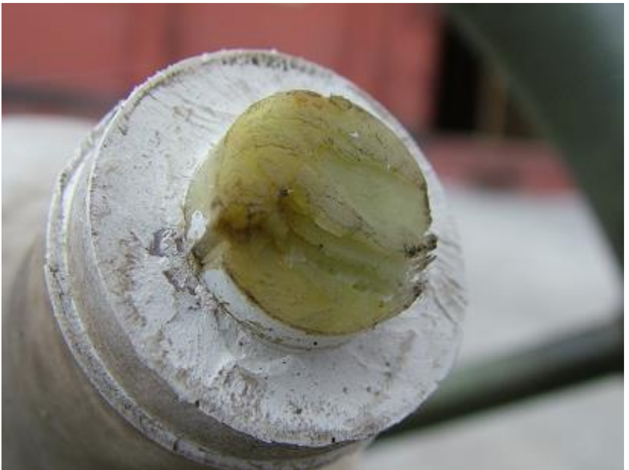
Рисунок 11 – Хрупкий излом изолятора
