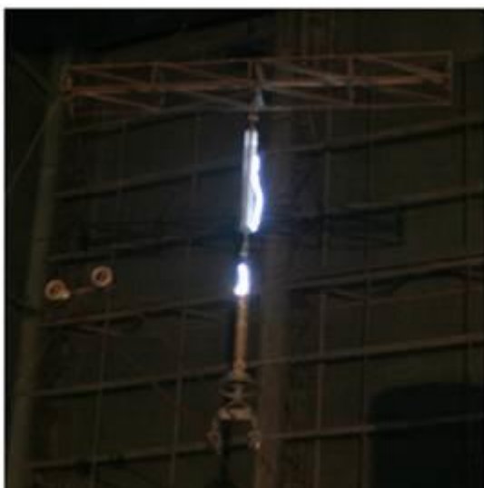
Рисунок 17 – Испытание напряжениями грозовых импульсов.
