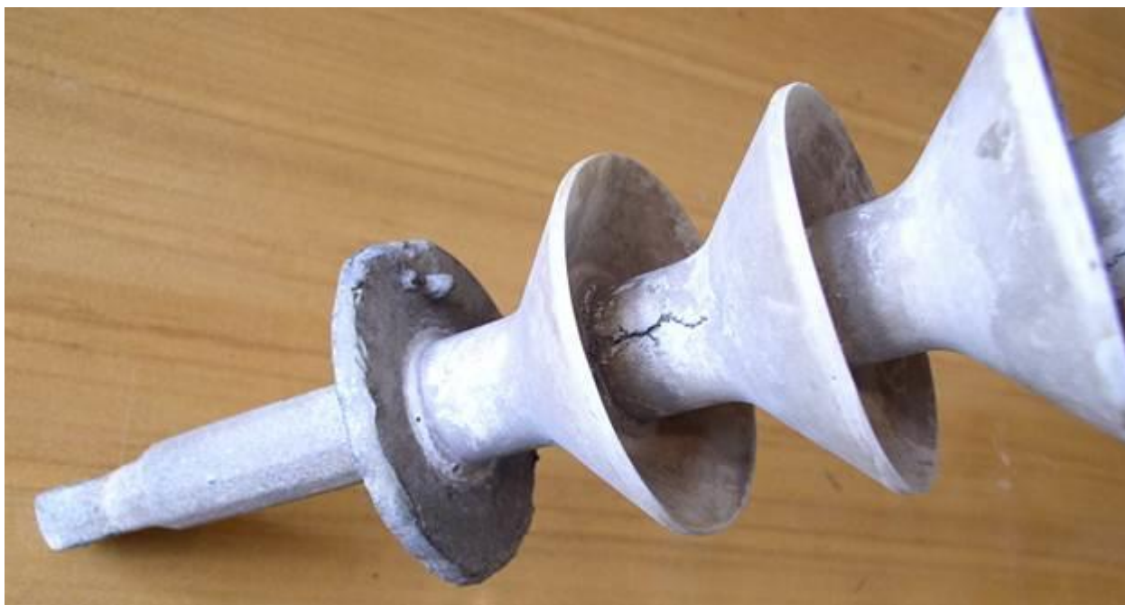
Рисунок 9 – Трек, эрозия защитной оболочки изолятора
