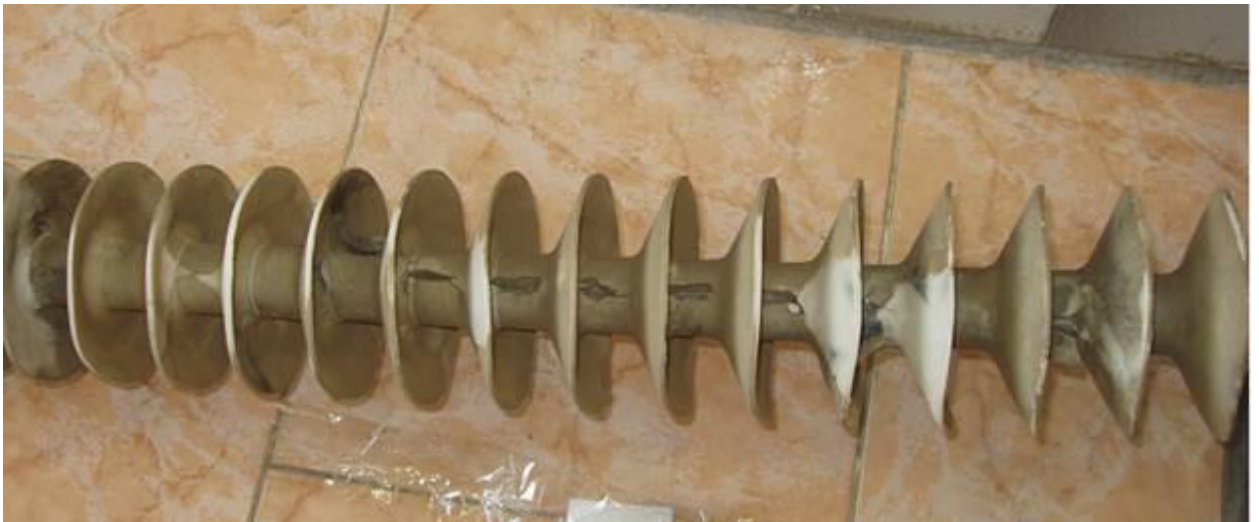
Рисунок 10 – Образование дендритов, треков на границе раздела, внутренняя эрозия защитной оболочки
