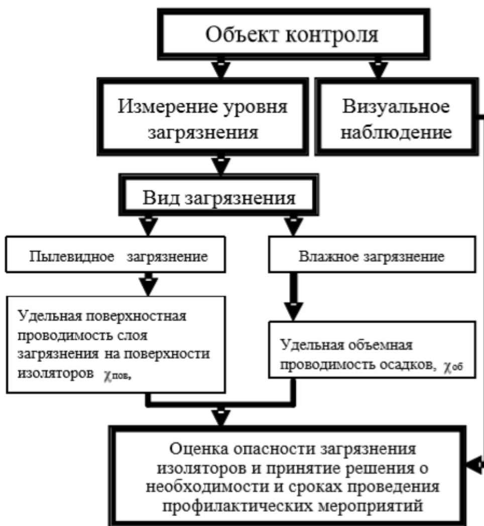
Рисунок 8 – Структура контроля состояния изоляции в процессе эксплуатации
