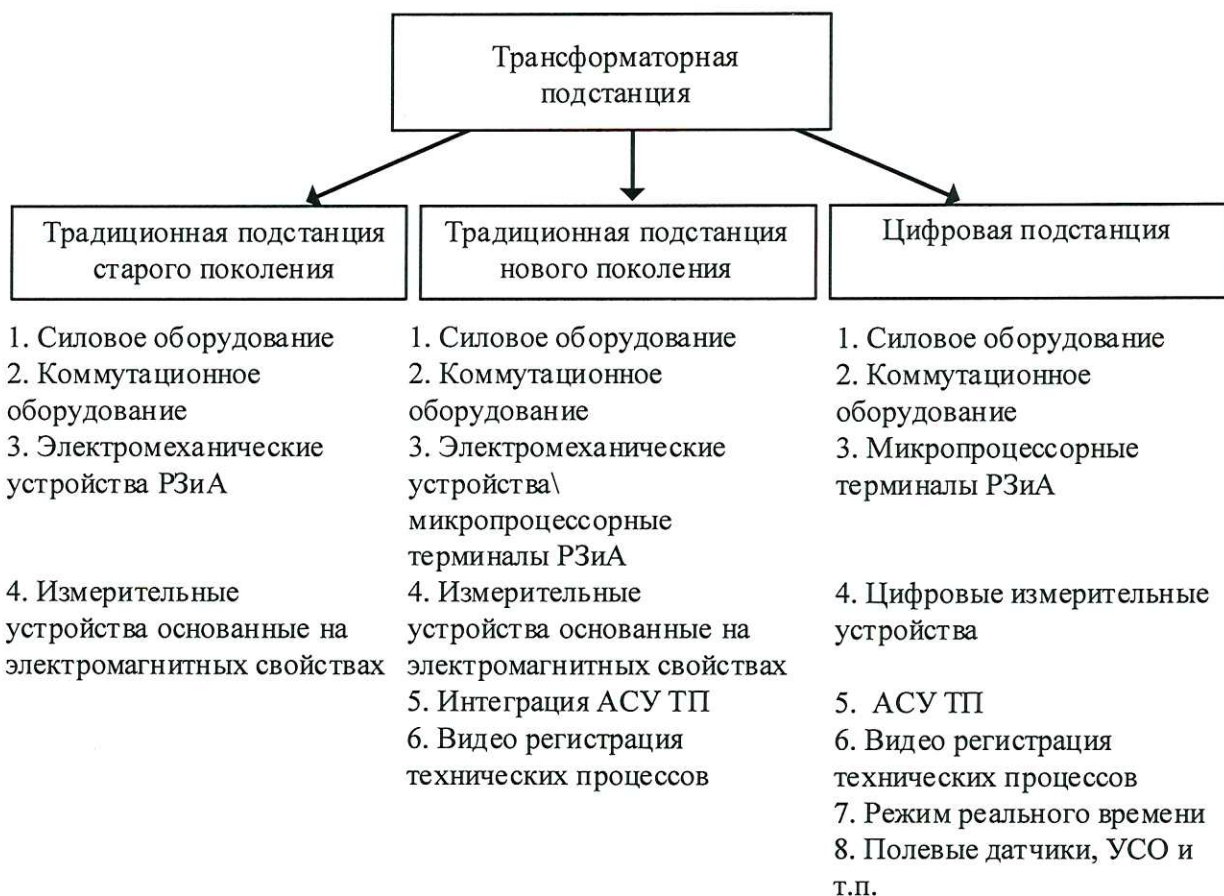
Рисунок 1.1 – классификация трансформаторных подстанций
