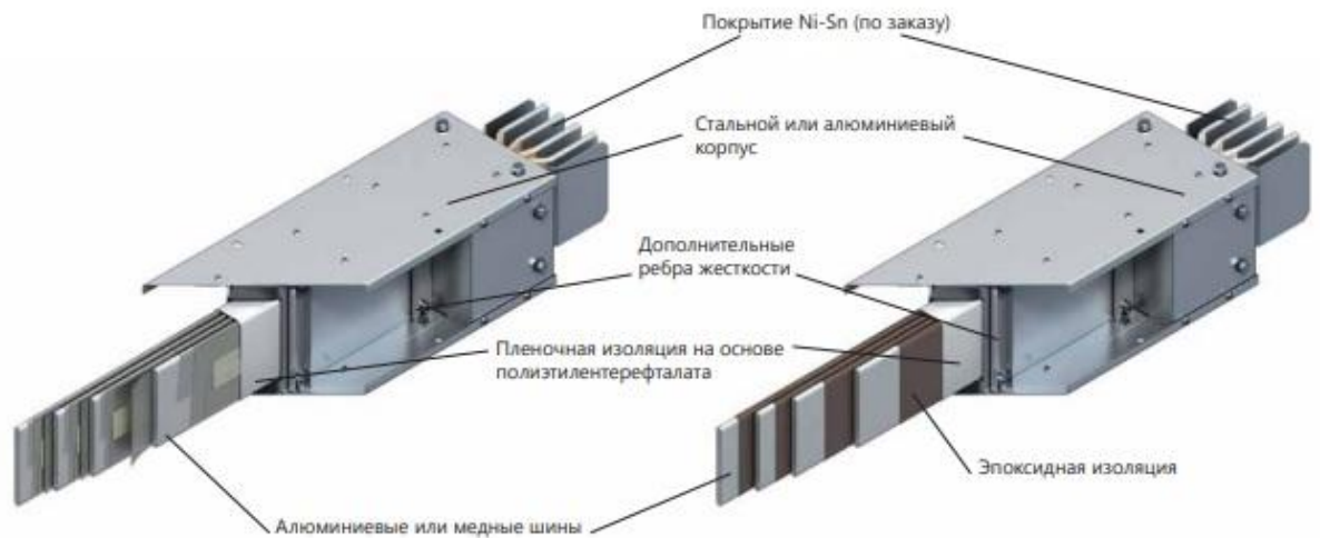
Рисунок 6 – Конструкция шинопровода
