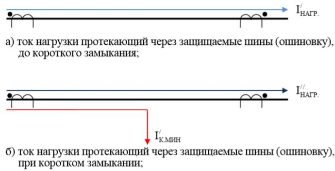
Рисунок 10 – Ток нагрузки, протекающий через защищаемые шины
