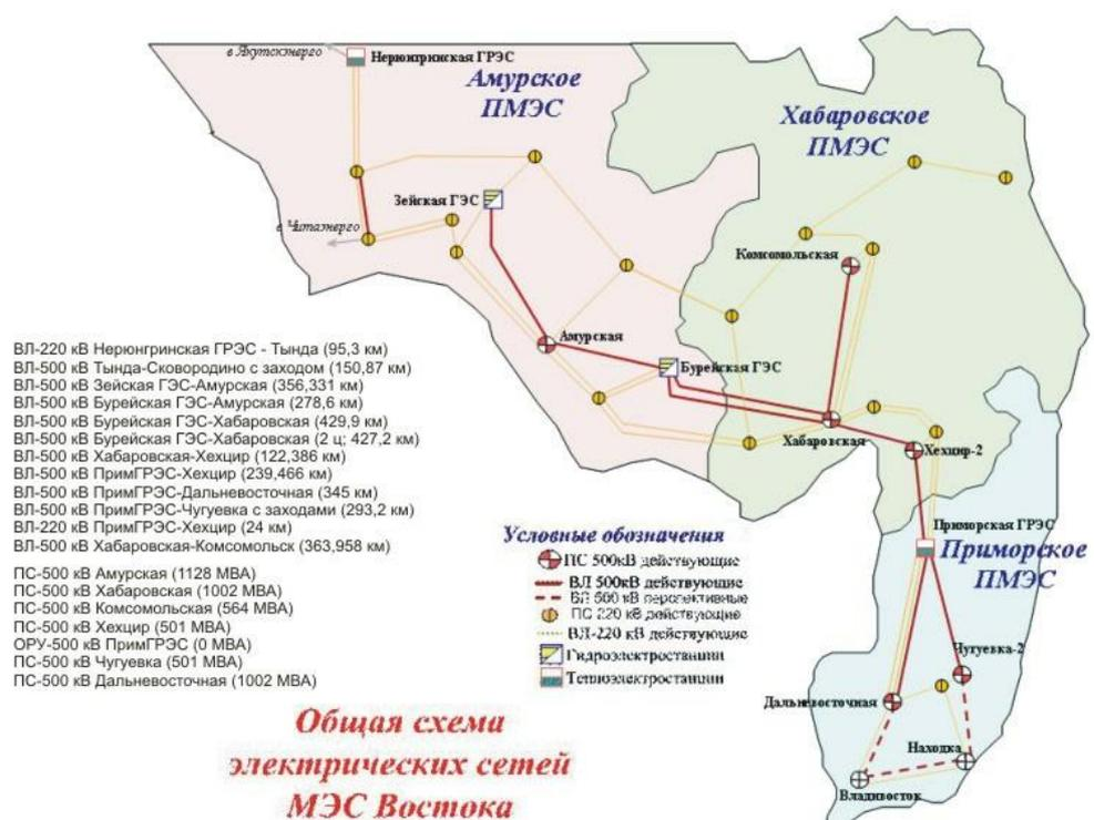
Рисунок 1 – Актуальная схема электрических сетей МЭС Востока
