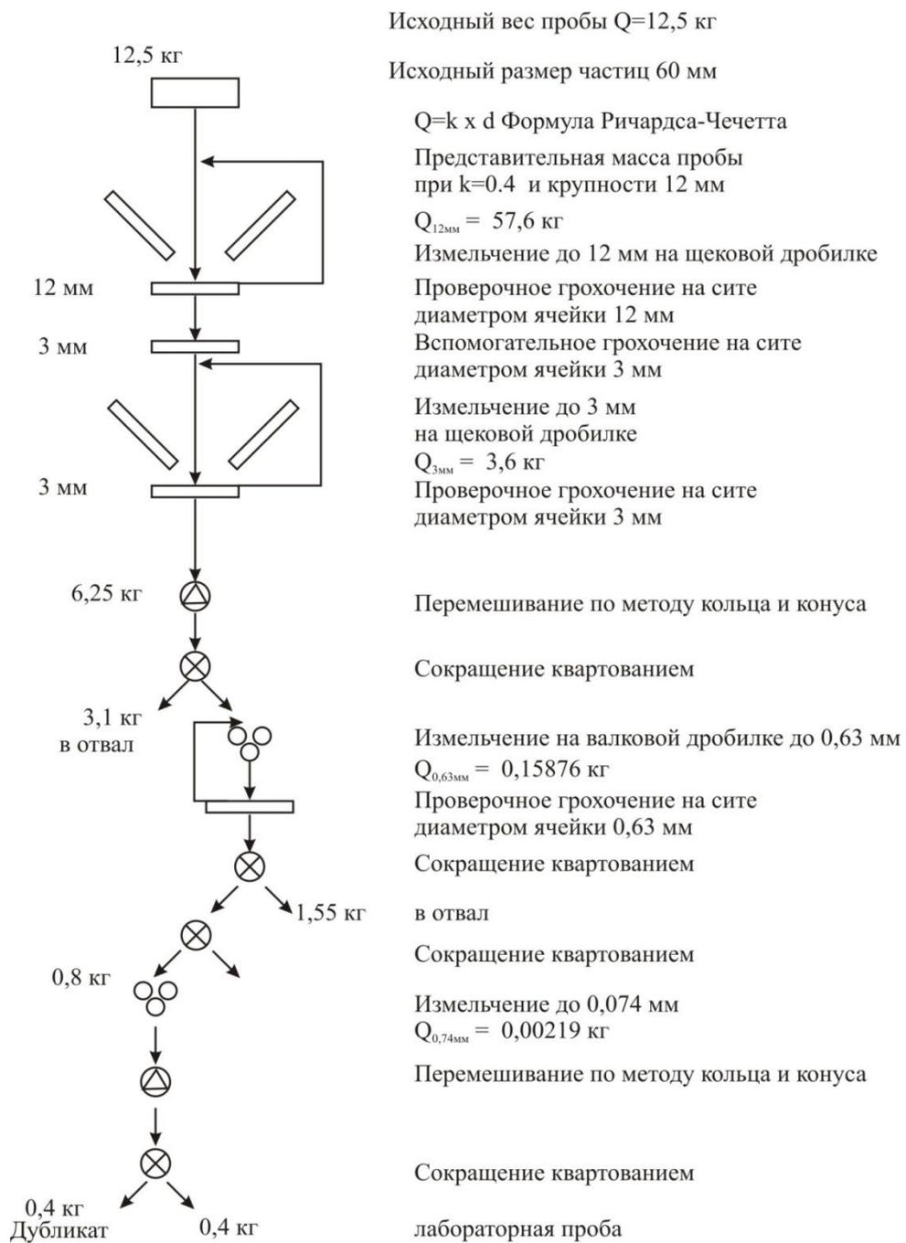
Рисунок 4 - Схема обработки бороздовых проб
