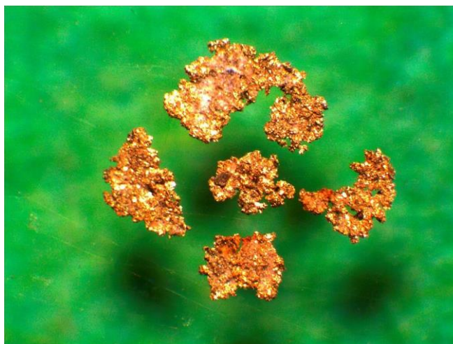
Рисунок 13 - Форма и характер поверхности золотин класса + 0,25 мм. Гравиоконцентрат - 0,071 мм. Увеличение 70 x
