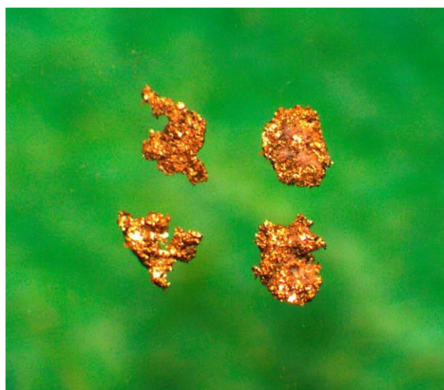
Рисунок 14 - Форма и характер поверхности золотин класса + 0,16 мм. Гравиоконцентрат - 0,071 мм. Увеличение 60 x
