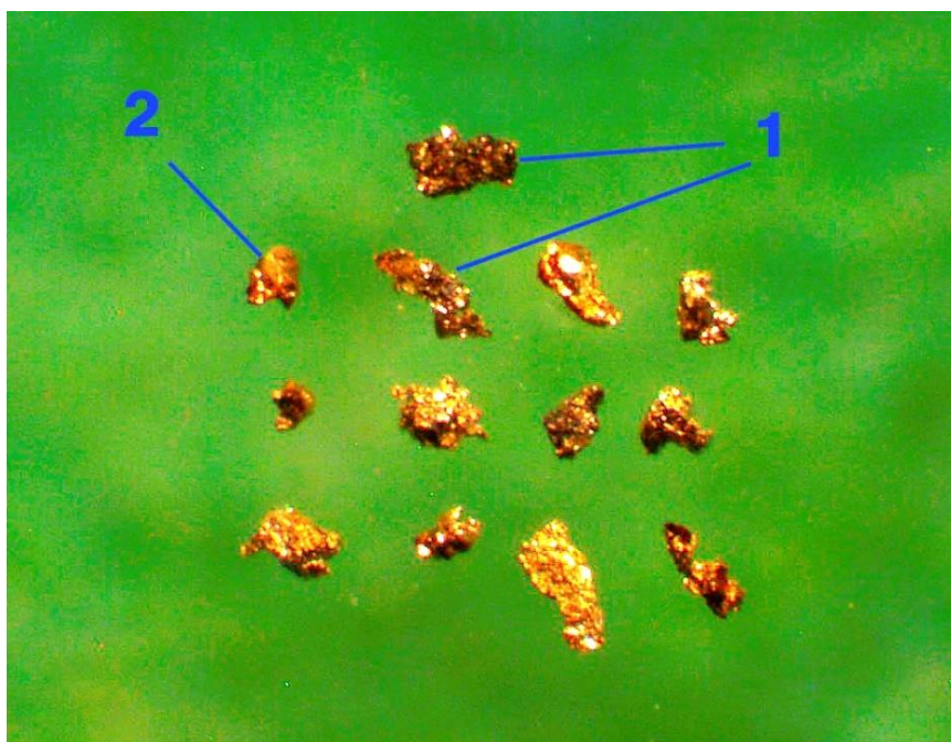
Рисунок 17 - Форма и характер поверхности золотинок класса + 0,05 мм. Золото в сростках с сульфидами (1) и кварцем (2). Гравиоконцентрат - 1,0 мм. Увеличение 65 x
