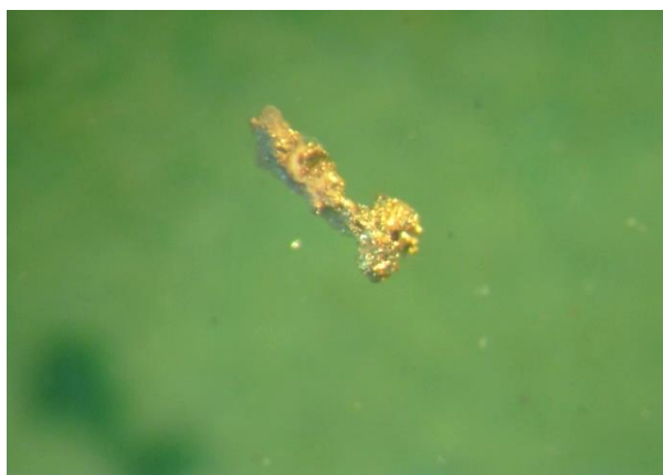
Рисунок 6 - Форма и характер поверхности золотины класса +1,0 мм с корками силикатного состава. Тяжелая фракция, выделенная гравитационным методом. Увеличение: 25 x
