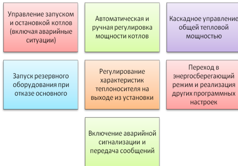
Рисунок 2 - Назначение системы автоматизации и диспетчеризации котельной
