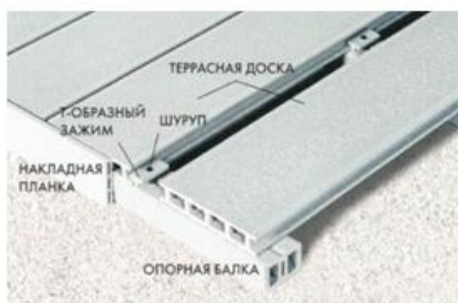
Рисунок Б.38 – Схема конструкции крепления декинга
