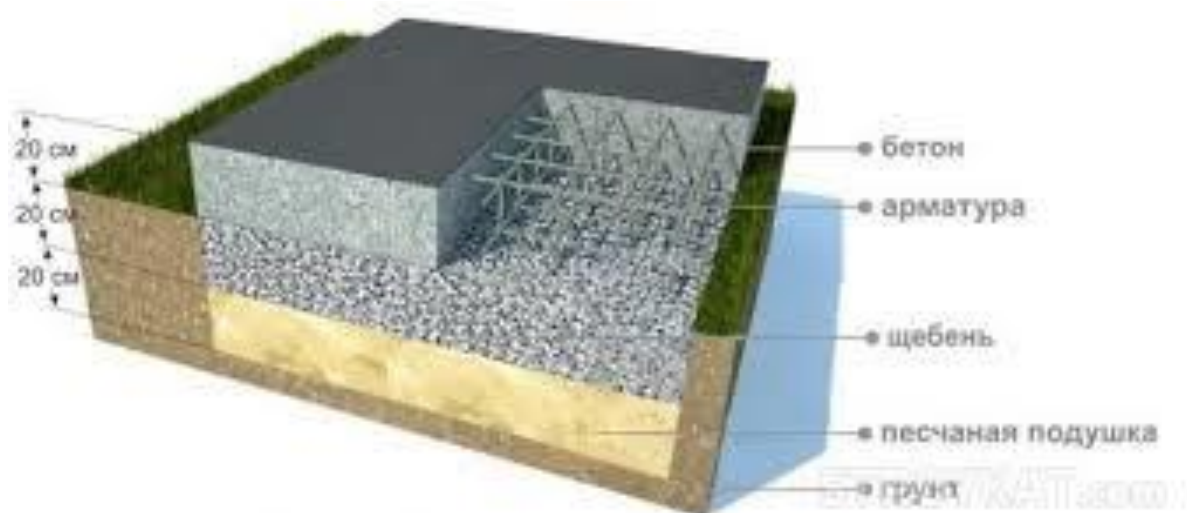
Рисунок В.4 – Схема укладки бетона
