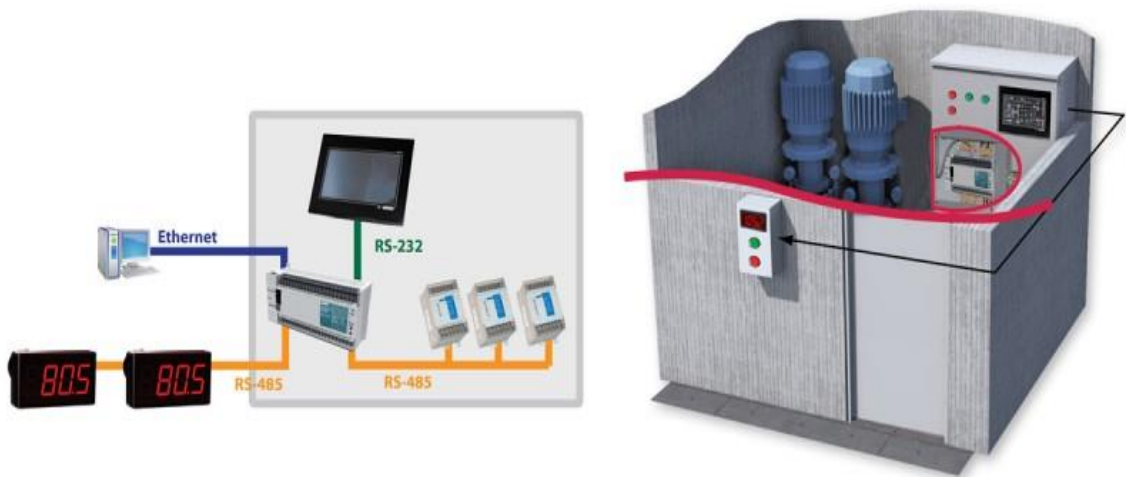
Рисунок 16 – Применение ОВЕН СМІ2 в кнопочных постах
