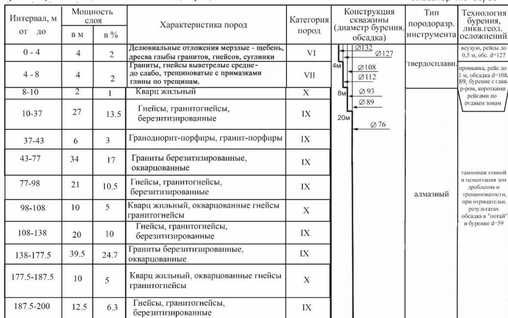
Рисунок 8 - Усредненный разрез и геолого-техническая карта для поисковых и оценочных скважин 3 группы
