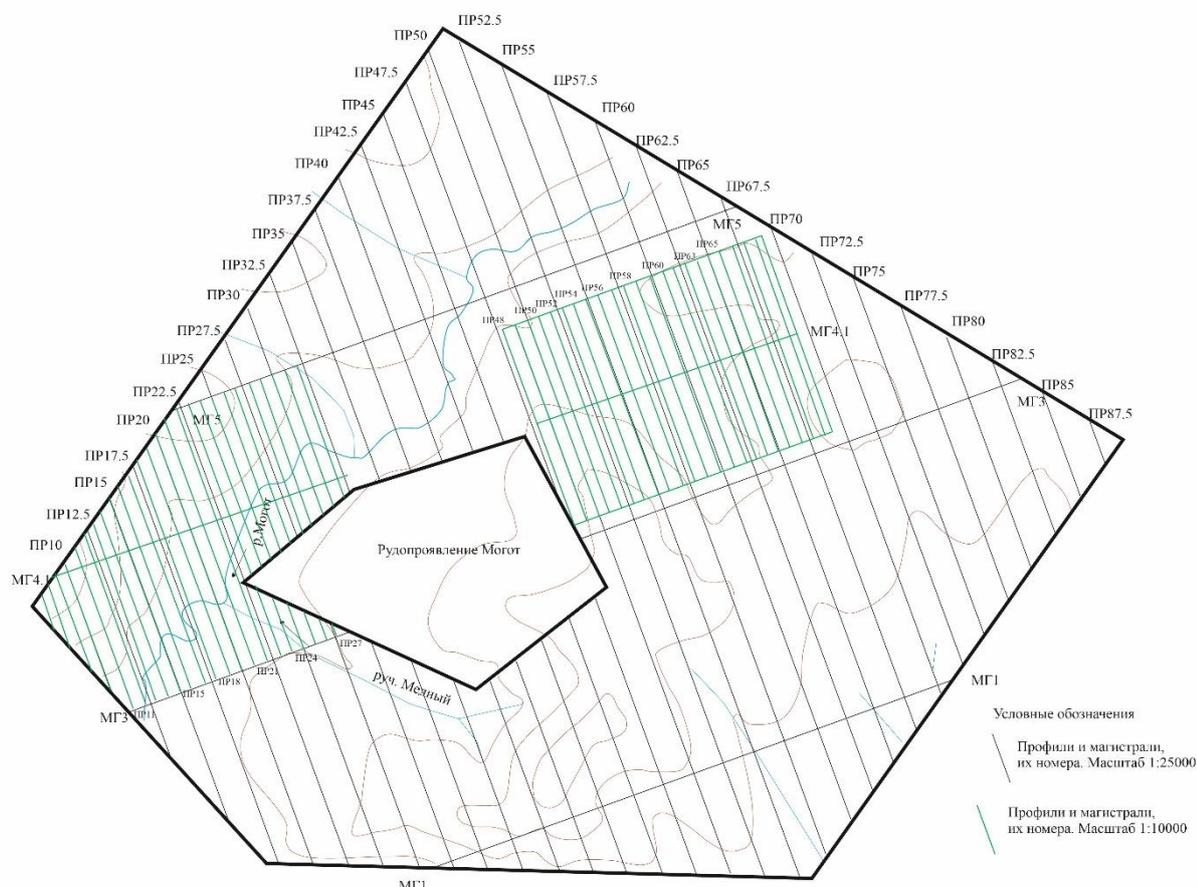
Рисунок 13.19 - Схема топографических работ поискового этапа
