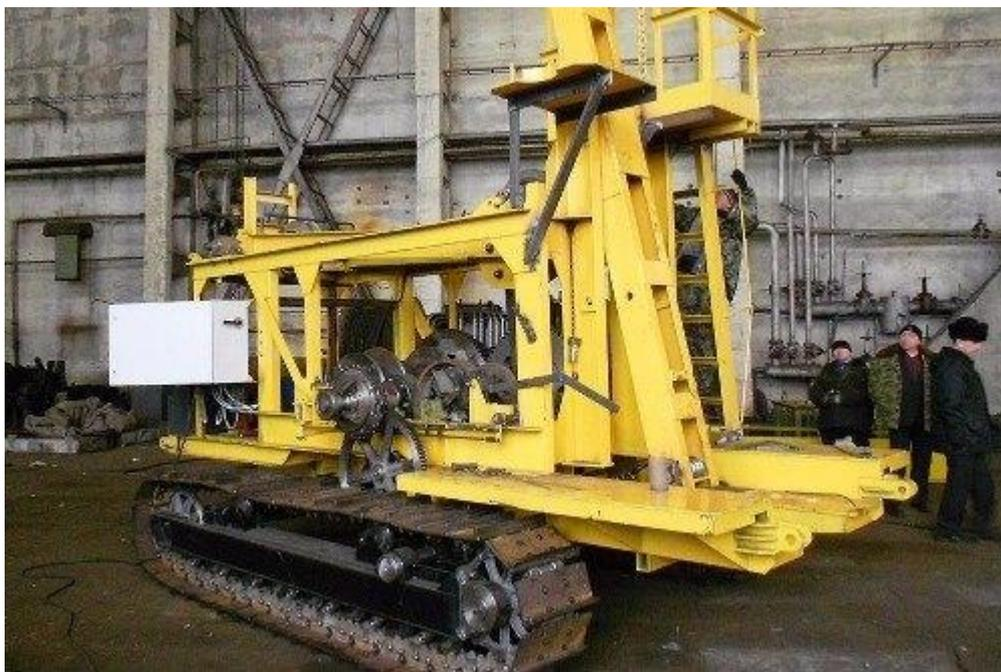
Рисунок 7 – Буровой станок БУ-20-2УШ
