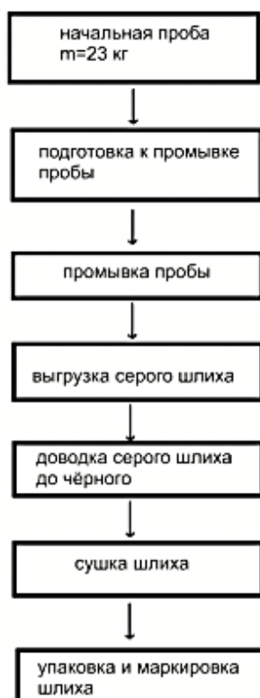
Рисунок 3 – Схема обработки шлиховых проб
