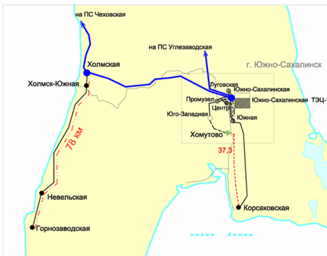
Рисунок 2 – Строительство двухцепной линии Холмская–Холмск-Южная–Правда–Невельская–Горнозаводская
