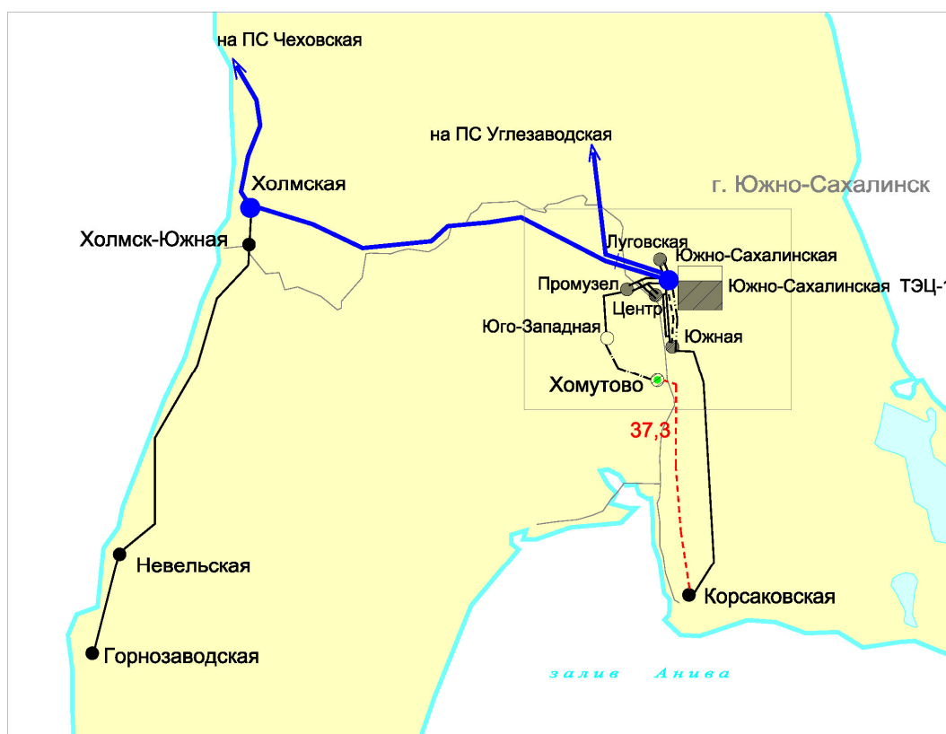
Рисунок 1 – Существующая схема электроснабжения южной части о. Сахалин
