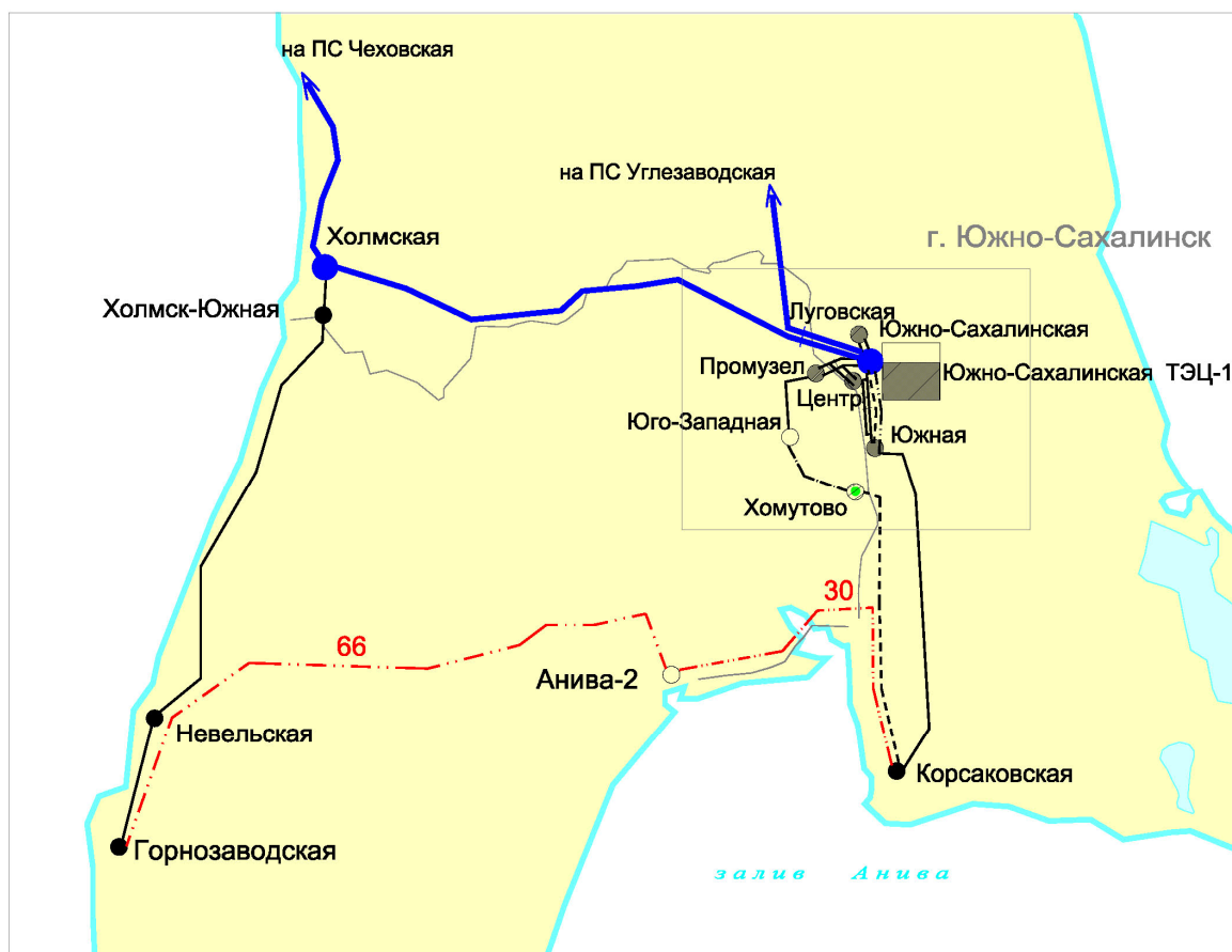
Рисунок 3 – Строительство одноцепной линии Корсаковская–Анива-2–Горнозаводская
