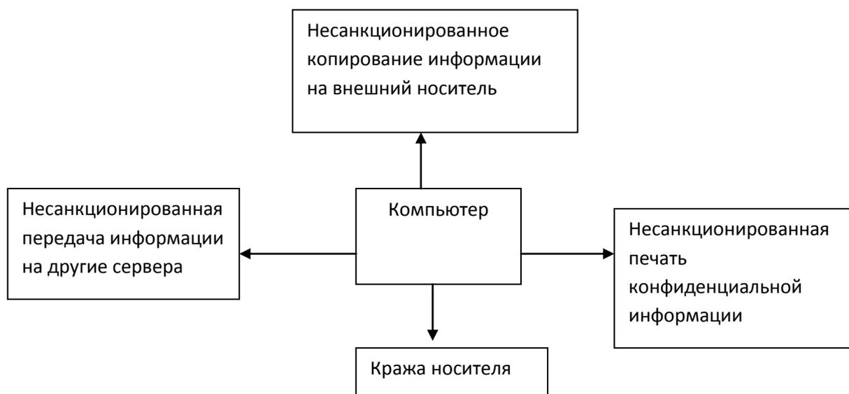
Рисунок 11 - Схема утечки конфиденциальной информации в автоматизированной системе с открытыми информационными каналами
