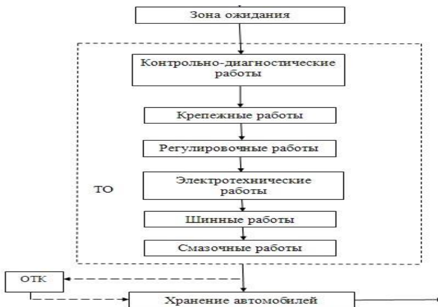
Рисунок 7 - Схема организации обслуживания в автосервисе ИП Масальский А.Б.
