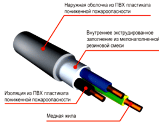
Рисунок 5 – Конструктивное исполнение кабеля ВВГнг-LS
