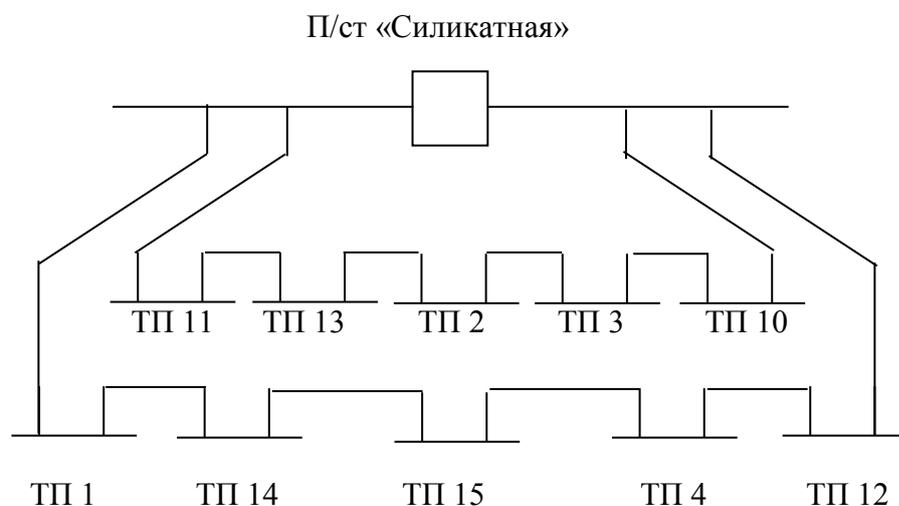
Рисунок 3 - Структурная схема распределительной сети (две петли)
