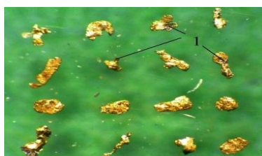
Рисунок 9 – Морфология и характер поверхности золотин
