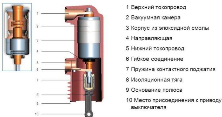
Рисунок 17 - Внешний вид выключателя VD4
