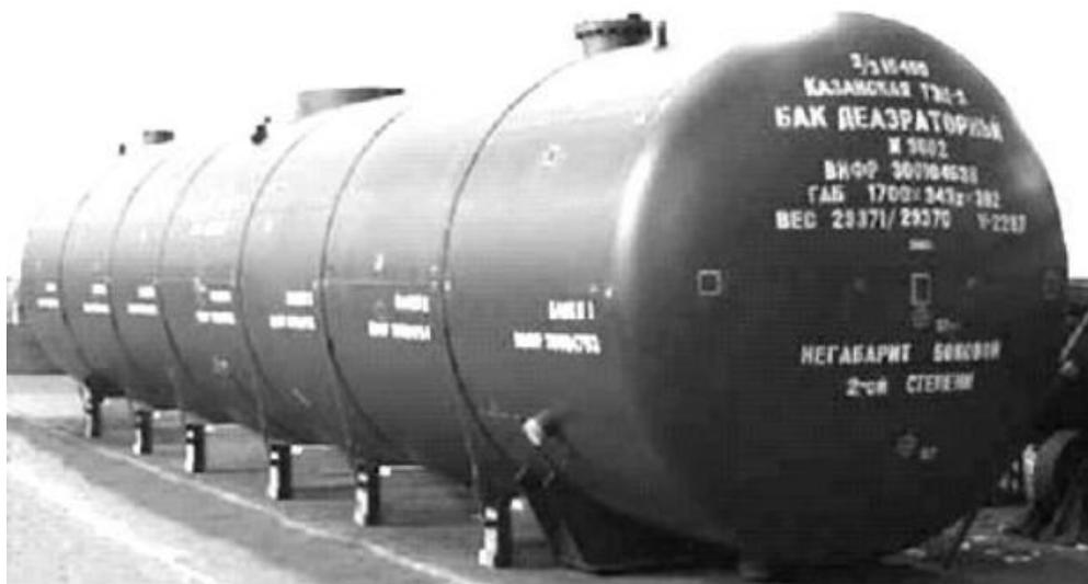
Рисунок 15 – Бак деаэратора ДП – 120
