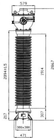
Рисунок 14 – трансформатор тока ТГ 245
