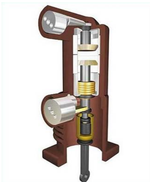
Рисунок 15 – Выключатель ВРС – 35 с пружинным приводом
