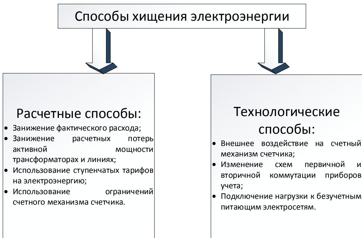
Рисунок 8 – Способы хищения электроэнергии
